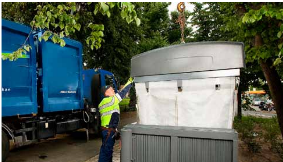
Nedgravede affaldscontainere, Deepline
